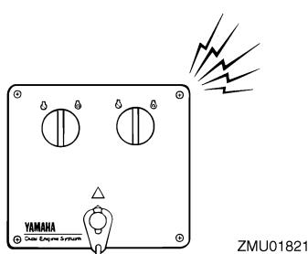
Se si attiva il sistema d'allarme, spegnete il motore e controllate che l'entrata dell'acqua di raffreddamento non sia ostruita.
