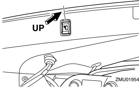
4. Spingete la manopola di supporto tilt nella staffa di bloccaggio o tirate verso di voi la leva di supporto tilt per sostenere il motore.
