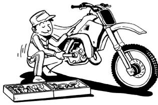
3. Lors du démontage de la moto, garder ensemble les pièces appariées. Il s'agit des engrenages, cylindres, pistons et autres pièces qui ont été "façonnées l'une à l'autre" par l'usure normale. Ces pièces doivent être réutilisées ensemble ou remplacées.
