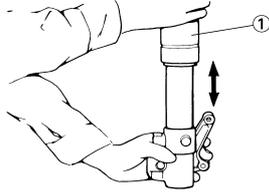
19. Attendre dix minutes jusqu'à ce que les bulles d'air aient disparu de la fourche et que l'huile se soit répartie uniformément dans le circuit avant d'ajuster le niveau d'huile comme préconisé.
