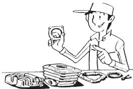
4. Lors du démontage de la moto, nettoyer toutes les pièces et les disposer dans des plateaux dans l'ordre du démontage. Ceci diminuera le temps de remontage et permettra de s'assurer que toutes les pièces ont été correctement remontées.
