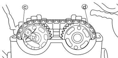
c. Mesurer le jeu aux soupapes "e" à l'aide d'une jauge d'épaisseur à lames "1".
