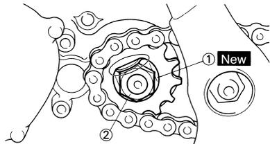
3. Plier l'onglet de la rondelle-frein pour bloquer l'érou.
